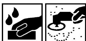
По истечении 3,5-4,0 часов при температуре +20°C можно удалить дефекты и вкрапления с помощью абразивных материалов:
